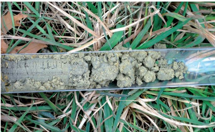
Muestra inalterada del suelo con agregados y poros de distinto tamaño.
